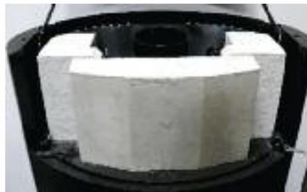
L'accumulateur de 55 kg se charge pendant la phase de combustion la plus rapide et restitue les calories lentement lorsque le feu ralentit. Ce système permet de lisser la température dans la pièce, en supprimant les pics de température et en chauffant plus longtemps qu'un poêle classique. Un vrai "plus" pour votre confort !
